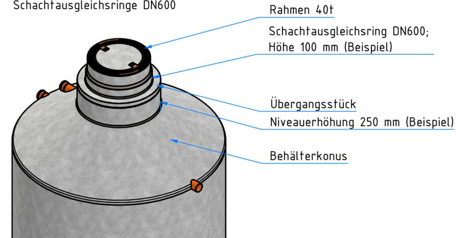
Alle Maßangaben sind Nennmaße nach Herstellung der bauseitigen Mörtelfugen zwischen oberer Konusöffnung / Niveauerhöhung(en) / Übergangsstück / Deckelrahmen. Istmaße können fertigungsbedingt abweichen und sind auf der Baustelle zu prüfen!
