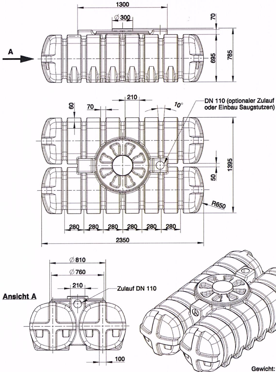
Abflusslose Sammelgrube aus Polyethylen (PE-LLD) zur Lagerung von häuslichem Abwasser 1500 l
